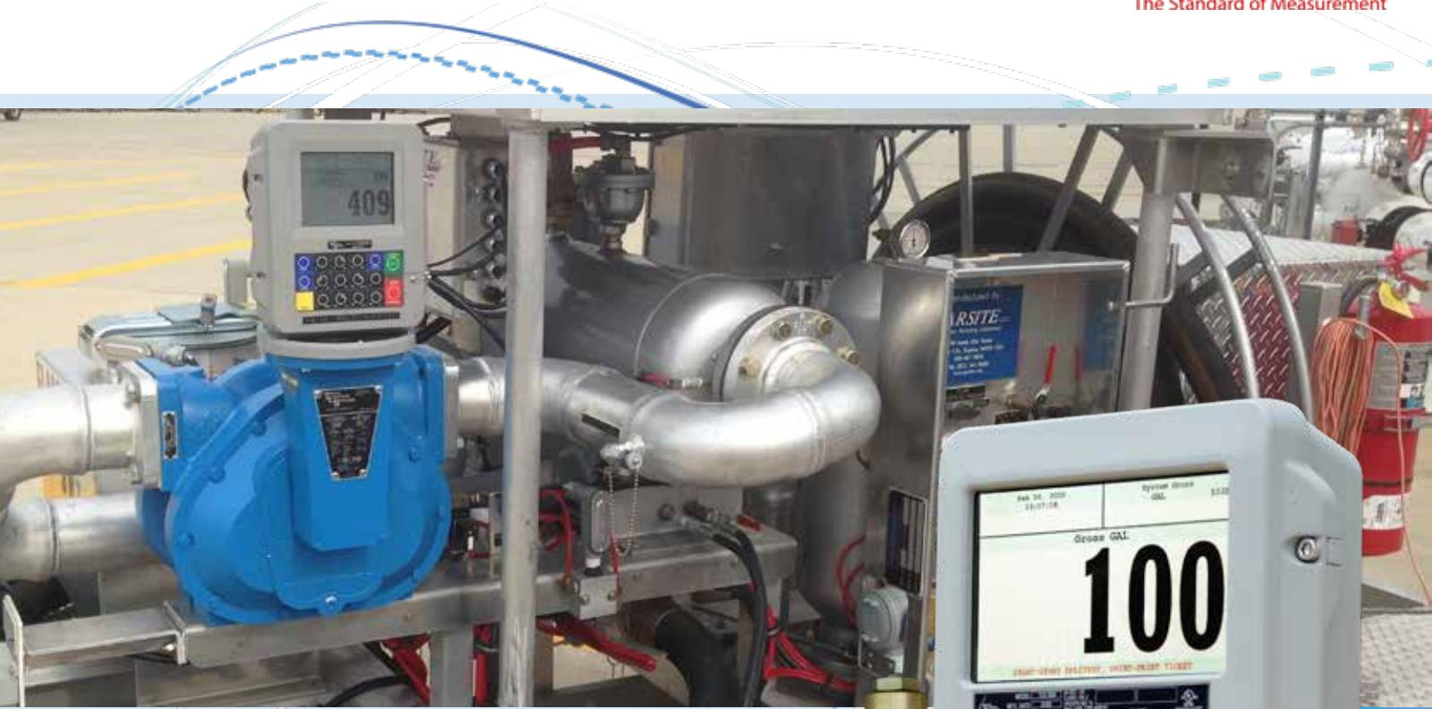
**Asegure la Alimentación Segura de la Aeronave con su Sobre Vista de la Presión Diferencial del Filtro y Apagar si Llega al Límite.**
